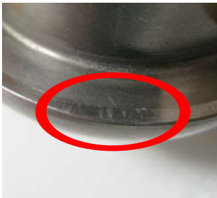
Verschleißspuren an einem Spannbolzen
