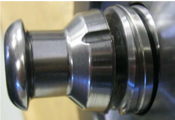
Gelöster Bolzen und herausgedrehte Spindel
