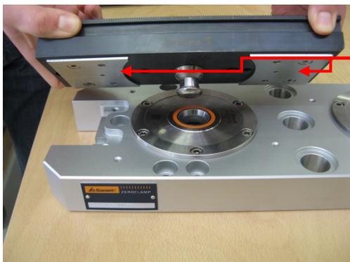
Bei einer Drehbaren Aufspannung empfiehlt der Hersteller, die Verwendung von Unterstüztungsplatten. Diese nehmen weitere Kräfte auf und sorgen für einen festen Sitz auf dem Spanntopf.
